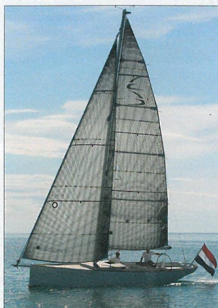
▲ Le bout-dehors fixe supporte l'étai, ce qui autorise un grand génois à faible recouvrement.
